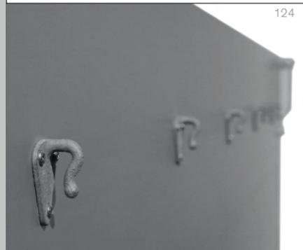
Die Verwendung eines Netzes zur Ladungssicherung wird mit diesen massiven Metallhaken einfacher denn je. Montiert sind die Haken außen an den Bordwänden oder außen am Aufsatz und stehen so jederzeit zur Verfügung.
