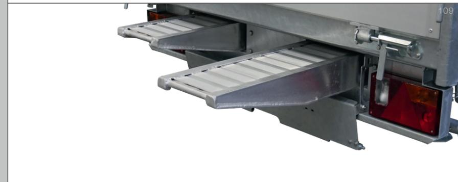
So lassen sich Baumaschinen oder andere Geräte einfach und sicher verladen. Die Alu - Auffahrampen stammen von einem deutschen Qualitätshersteller. Verstaut werden können die Alu-Auffahrampen in Einschubfächern am Heck.
