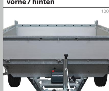
Die massiven Zurrschienen sind auch für die vorderen und hinteren Bordwände erhältlich. In Kombination mit den seitlichen Zurrschienen können so Spanngurte rundherum eingehakt und die Ladung kann sicher verzurret werden.
