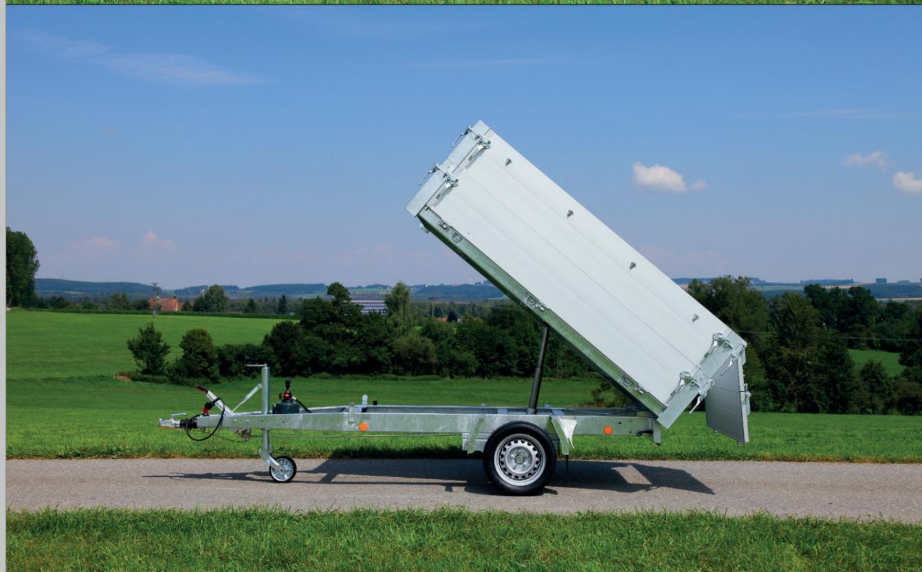
Für große Raumsprüche: Der 350 mm bzw. 700 mm hohe Alu-Aufsatz verdoppelt das Ladevolumen Ihres Kipp-Anhängers und macht diesen mit wenigen Handgriffen zu einem Platzwunder. Das extra Plus an Stabilität garantieren die durchgehend doppelwandigen Alu-Profile, aus welchen der Aufsatz gefertigt ist. Auf Wunsch ist er selbstverständlich auch aus Mammut-Profilen erhältlich. Ein-
