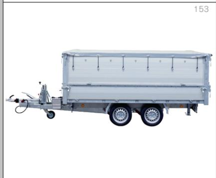
Sicherung von kleinteiligem Ladegut, Witteungsschutz, kein Verhaken z.B. an Ästen – das sind die Vorteile der Abdeckplane. Aufgerollt an der Front des Anhängers ist die strapazierfähige Plane mit Gewebeeinlage jederzeit einsatzbereit.
