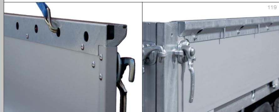
Die Zurrschienen bieten zum einen die Möglichkeit Kleingeräte oder Material daran zu verzurren, zum anderen sind sie ein massiver Rammschutz und schützen so die Bordwände. Die an der Außenkante eingeschweißten Zapfen sind perfekt für die
