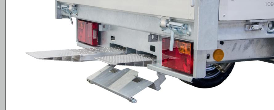
So lassen sich Baumaschinen oder andere Geräte einfach und sicher verladen. Die Alu - Auffahrrampen stammen von einem deutschen Qualitätshersteller. Verstaute werden können die Alu-Auffahrrampen in Einschubfächern am Heck.
