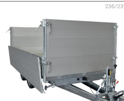
Leichtes Beladen von der Seite, auch mit Aufsatz: Mit dieser Option können Sie die rechte, linke oder beide Seiten des Aufsatzes abklappen und den Anhänger leicht von der Seite aus beladen. Plus: Auch die untere Bordwand kann geöffnet werden.
