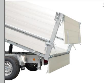
Komfortabler Zugang: Die hintere Aufsatzwand ist hier abklappbar. So kann der Anhänger auch bei aufgesetztem Aufsatz leicht be- und entladen werden.
