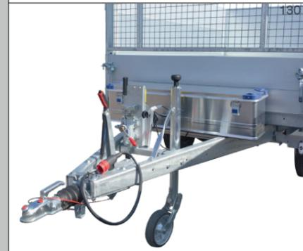
Mit der praktischen Staubox sind die wichtigsten Gegenstände (Netz, Spanngurte etc.) immer an Bord. Auf der Deichsel\* oder am Stirnwandgestell montiert.
