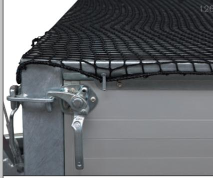
Ein auf die Anhängergröße abgestimmtes Netz mit Randverstärkung ist eine effektive und praktische Lösung zur Ladungssicherung. So kann auch kleinteiliges oder loses Ladegut sicher transportiert werden.
