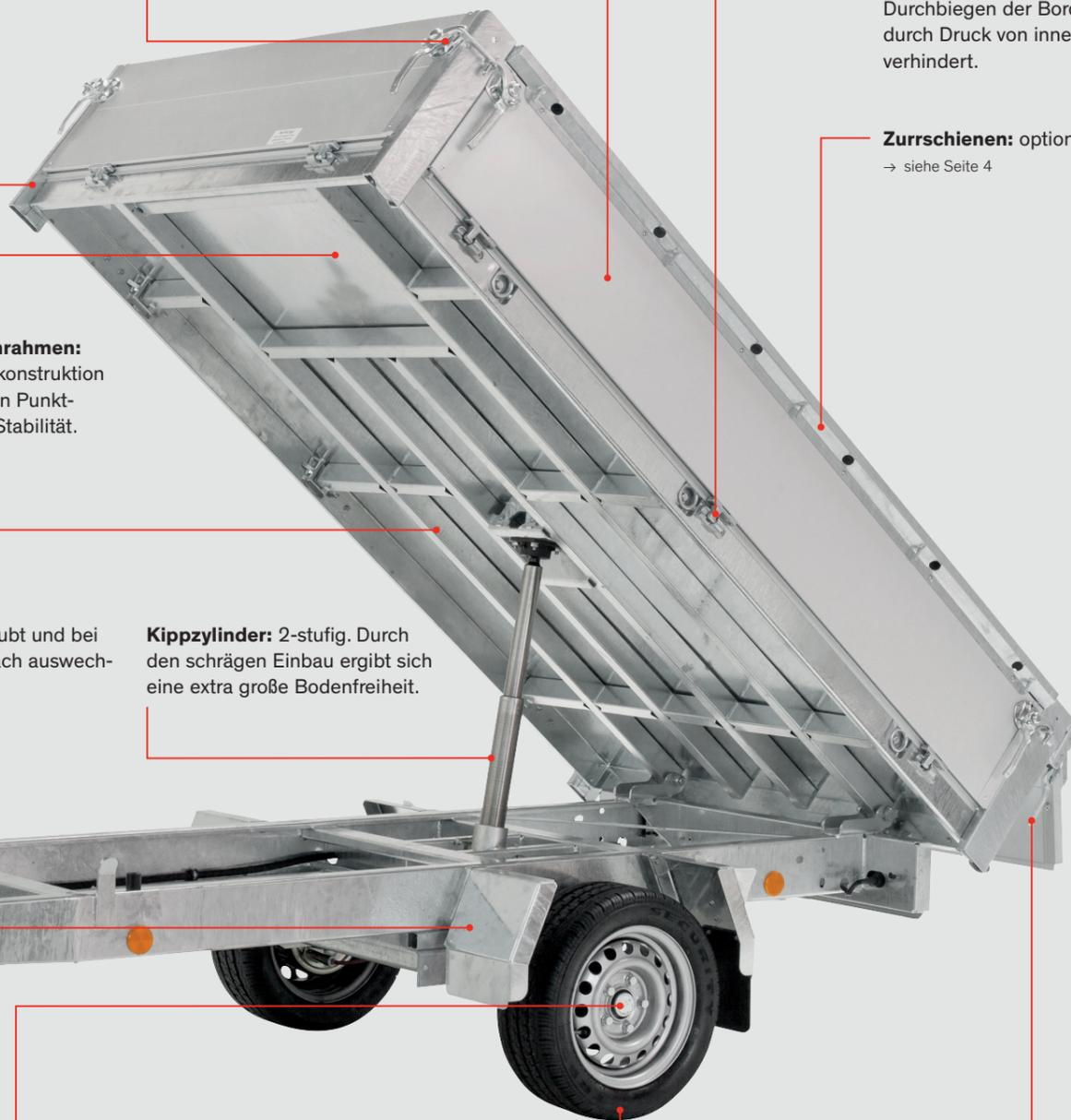
**Bordwände:** Gefertigt aus durchgehend doppelwandigen Alu-Profilen (optional auch aus Mammut-Profilen für noch mehr Stabilität → siehe Seite 4). Abklapp- und aushängbar.
