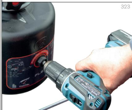
Einfacher geht's nicht: Abkippen mittels Akku-Schrauber. Die normale Funktion der Handpumpe bleibt erhalten.
