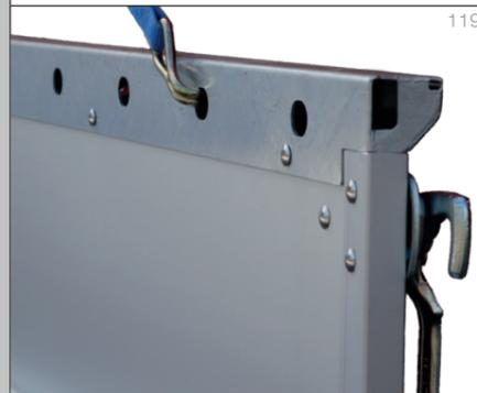
Die Zurrschienen bieten zum einen die Möglichkeit Kleingeräte oder Material daran zu verzurren, zum anderen sind sie ein massiver Rammschutz und schützen so die Bordwände. Die an der Außenkante eingeschweißten Zapfen sind perfekt für die
