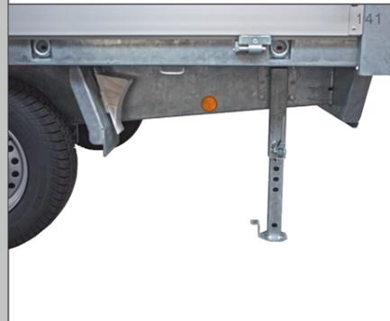
Die stabilen Abstellstützen am Heck sind einfach zu bedienen und bieten zusätzliche Sicherheit während des Verladens von schwerem Gerät.
