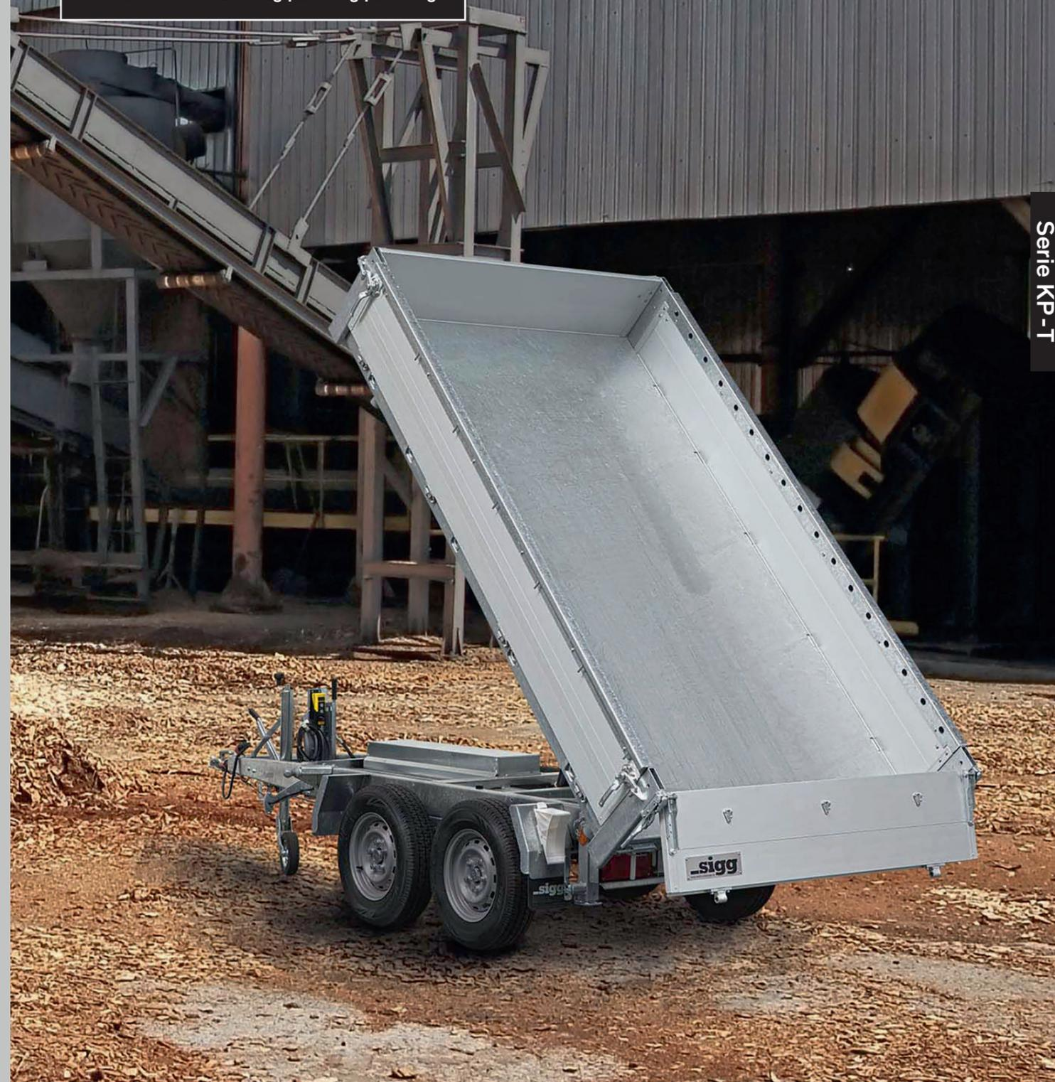
**Massiver Pritschenrahmen:** Die stabile Rahmenkonstruktion sorgt auch bei hohen Punktlasten für optimale Stabilität. Feuerverzinkt.
