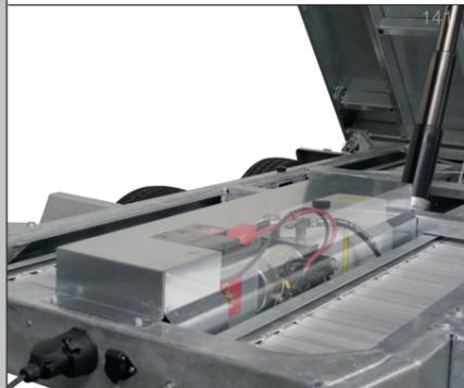
Abkippen per Knopfdruck: Die Elektropumpe erleichtert Ihnen die Arbeit ganz erheblich. Sie wird von einer eigenen leistungsstarken Marken-Batterie (88 Ah) betrieben und ist mit dieser unter einer Abdeckung geschützt eingebaut.
