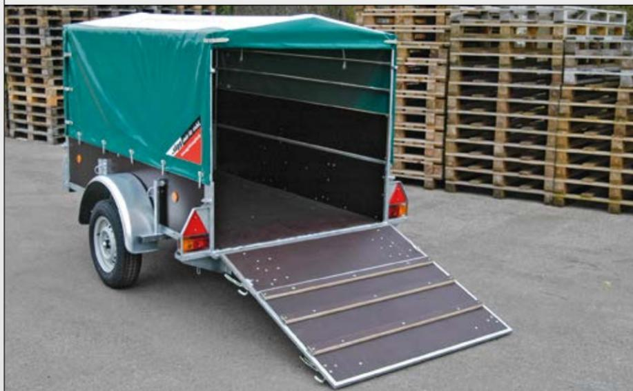
Mit diesem Aufbau lassen sich bequem Kleintiere (Ferkel, Schafe, Kälber etc.) transportieren. Zum Schutz der Plane ist das Verdeckgestell vorne und an den Seiten mit einem zusätzlichen Planenschutz ausgestattet. Ein spezielles Profil schließt die Lücke zwischen Anhänger und Heckklappe und lässt die Tiere bequem einsteigen. Der Kleinvieh-Aufbau und die aufsteckbare Laderampe können mit wenigen Handgriffen abgenommen werden. So bleibt Ihr Anhänger flexibel einsetzbar.
