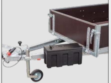
In dieser Staubox bringen Sie ein Netz und Zurrgurte bequem unter. Die Staubox besteht aus Kunststoff und ist abschließbar. Außenmaße: 515 x 220 x 277 mm. Ab einer Anhängerlänge von 2150 mm möglich.
