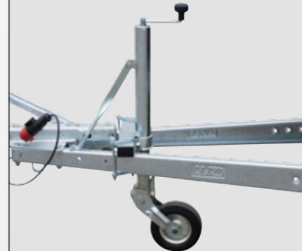
Das verstärkte Stützrad mit 60mm starkem Außenrohr ist zwischen der V-Deichsel montiert. Es hat eine Abstützung auf die Deichsel und einen automatischen Umklapp-Mechanismus. Nur bei gebremsten Anhängern möglich.
