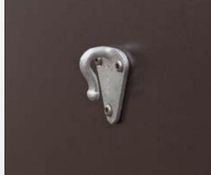
Die Verwendung eines Netzes zur Ladungssicherung wird mit den massiven Metallhaken, die außen an den Bordwänden oder außen am Aufsatz montiert werden, zum Kinderspiel.
