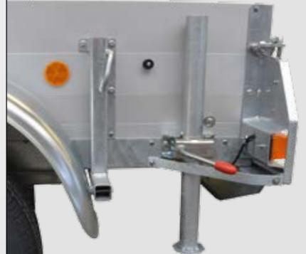
Die stabilen Schiebestützen am Heck bringen zusätzliche Stabilität während des Verladevorganges. Sie sind dank der massiven Klemmschelle stufenlos an den Untergrund anpassbar.
