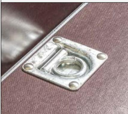
Ladungssicherung leicht gemacht: Die Zurmulden sind in den Boden eingelassen. So sind die massiven Zurrösen bei Bedarf stets einsatzbereit.
