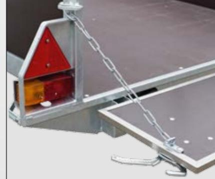
Für Langmaterial: Optional können Sie die vordere und hintere Bordwand mit Auslegeketten versehen. So lassen sich die Bordwände waagrecht hängen und überlanges Ladegut kann sicher transportiert werden.
