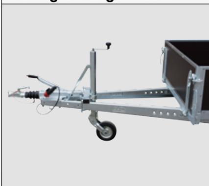
Ideal für den Transport von Langmaterial: die verlängerte Zugdeichsel. So lassen sich auch lange Güter stützlastgerecht über der Achse zentriert verladen. Freie Deichsellänge: ca. 1700 mm.
