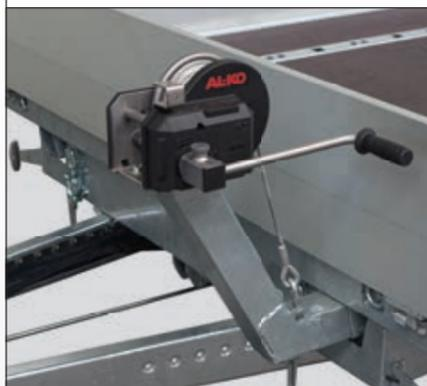
Die mechanische Seilwinde lässt sich vorne am Rahmen adaptieren, bei der Tandem-Ausführung sogar an zwei verschiedenen Positionen.
