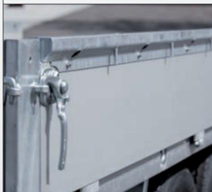
Die zum Gebrauchsmuster angemeldeten Zurrschienen bieten zum einen die Möglichkeit, Kleingeräte oder Material daran zu verzurren, zum anderen sind sie ein massiver Rammschutz und schützen so die Bordwände. → siehe Seite 5
