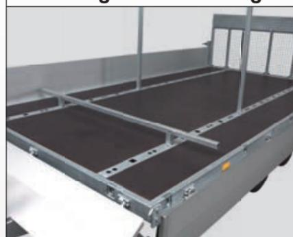
Sicherungsrunge und -traversen, die zusätzlich in das FloorFixSystem eingesteckt werden können, sichern das Ladegut vor dem Verrutschen und ermöglichen eine formschlüssige Ladungssicherung. → siehe Seite 4
