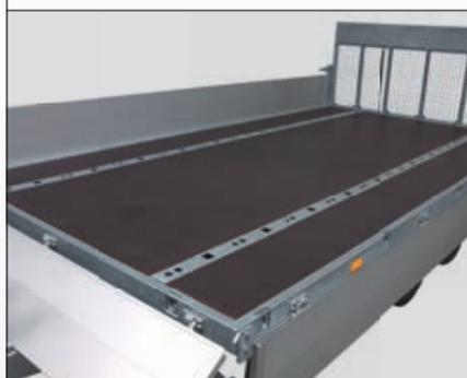
Schnelle und formschlüssige Ladungsicherung mit dem FloorFixSystem von Sigg. Das Ladegut lässt sich flexibel an den Öffnungen der Ankerschienen verzurren.
