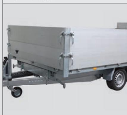
Mit wenigen Handgriffen kann ein 350 mm hoher Aufsatz montiert und so das Ladevolumen verdoppelt werden. Der Aufsatz ist aus durchgehend doppelwandigen, eloxierten Alu-Profilen gefertigt – auf Wunsch auch aus Mammut-Profilen.
