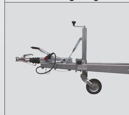
Die auf 1700 mm verlängerte V-Deichsel ist ideal für alle, die oft lange Güter wie Bretter, Balken, Rohre etc. transportieren und dazu die Bordwände abklappen müssen.
