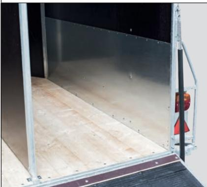
Der feuerverzinkte Trittschutz schützt die Bordwände vor dem Verschleiß durch Huftritte. So bleiben die Bordwände intakt. Dies trägt maßgeblich zu deren Langlebigkeit bei.
