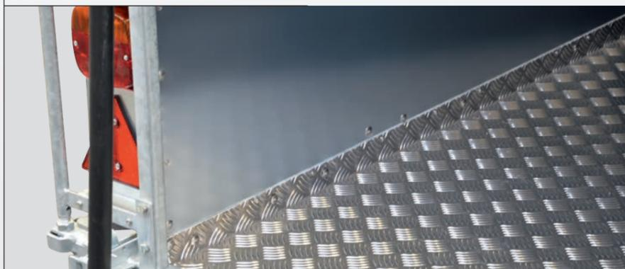
Äußerst robust und langlebig: Der Alu-Riffelblech-Boden ist aus einem Stück gefertigt und an den Seiten nach oben gekantet. So entsteht eine leicht zu reinigende Wanne. Praxistipp: Hier ist der Einsatz einer zusätzlichen Gummimatte unbedingt empfehlenswert.
