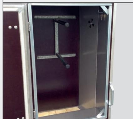
Die in den Anhänger integrierte Sattelkammer aus Edelstahl bietet Platz und Vorrichtungen für zwei Sättel. Sie ragt zur einen Seite in den Innenraum des Anhängers hinein und zur anderen Seite in den Außenraum.
