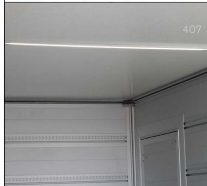
Alles im Blick: Dank der quer im Dach ver-bauten LED-Lichttraverse haben Sie auch in dunkler Umgebung und bei Nacht Ihre Ladung vollständig im Blick.
