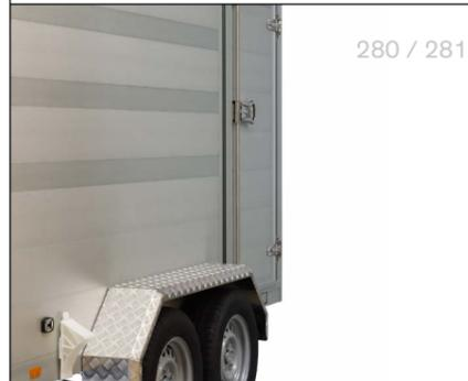
Links, rechts oder beidseitig können Sie Ihren Kofferranhänger mit einer Seitentüre ausstatten. Diese ist mit einem Drehstangenverschluss und Scharnieren aus Edelstahl versehen und abschließbar. Durchgangsbreite: 700 mm
