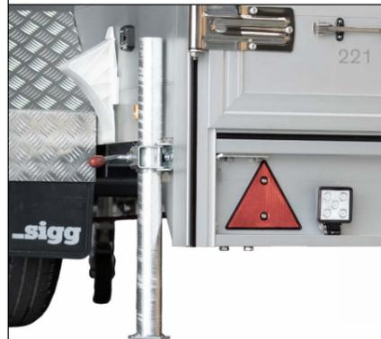
Durch die Schiebestützen am Heck gesichert, kann der Anhänger auch im nicht angehängten Zustand beim Be- und Entladen problemlos betreten werden. Die Stützen sind schnell und mit nur einem Handgriff einsatzbereit.
