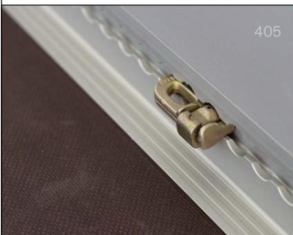
Das Doppel-Airline-Fitting ohne Ring kann flexibel entlang der Airline-Schiene des Multi-Fix-Profiles eingesetzt werden. Es bietet einen flexiblen Zurrpunkt für schmale Zurrbänder oder Gurte mit kleinen Haken.
