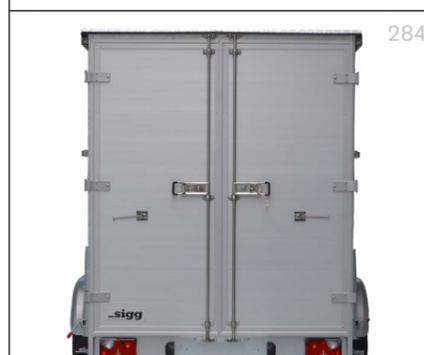
Flexibel: Ein zweiter Drehstangen-verschluss aus Edelstahl lässt Ihnen die Wahl einen Teil der Doppelflügel-Tür verschlossen zu lassen und trotzdem bei Bedarf den Anhänger über die gesamte Breite zu öffnen.
