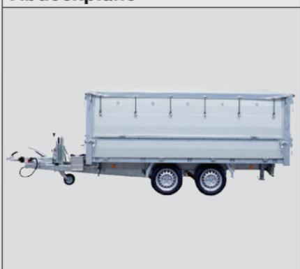
Sicherung von kleinteiligem Ladegut, Witterungsschutz, kein Verhaken z.B. an hervorstehenden Ästen – das sind die Vorteile der Abdeckplane. Aufgerollt an der Front des Anhängers ist die strapazierfähige Plane mit Gewebeeinlage jederzeit einsatzbereit.
