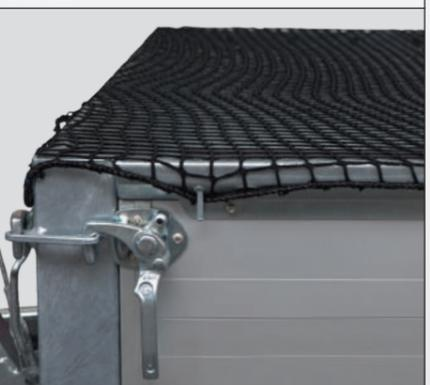
Ein auf die Anhängergröße abgestimmtes Netz mit Randverstärkung ist eine effektive und praktische Lösung zur Ladungssicherung. So kann auch kleinteiliges oder loses Ladegut sicher transportiert werden.
