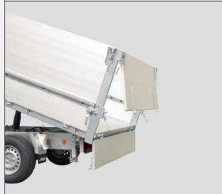
Komfortabler Zugang: Die hintere Aufsatzwand ist hier abklappbar. So kann der Anhänger auch bei aufgesetztem Aufsatz leicht be- und entladen werden.
