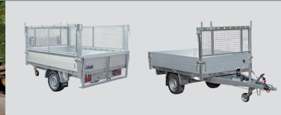
Großteiliges Schüttgut, wie Brennholz oder Grünschnitt lässt sich mit dem 700 mm hohen Stahlgitteraufsatz einfach und in großer Menge transportieren. Rundum feuerverzinkt ist er robust und von langer Lebensdauer. Der Stahlgitteraufsatz ist am Heck mit Pendelverschlüssen ausgestattet, sodass das Ladegut beim Abkippen
