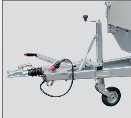
Das verstärkte Stützrad ist zwischen der V-Deichsel auf einer Traverse montiert. Es hat eine Abstützung auf die Deichsel. Es klappt zudem automatisch um.
