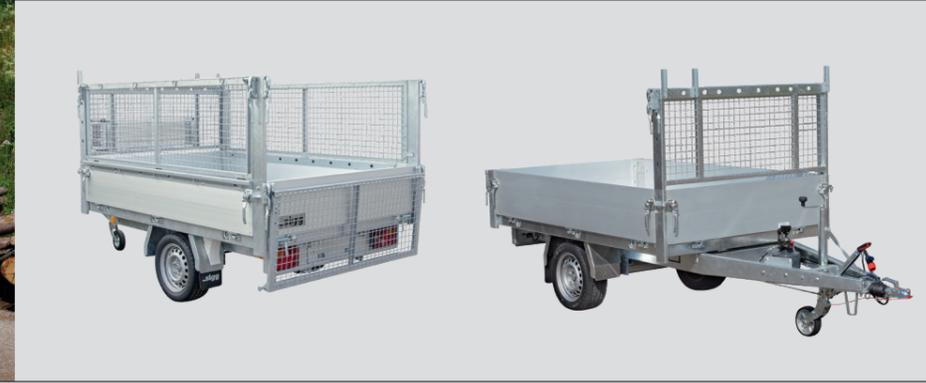
Grobteiliges Schüttgut, wie Brennholz oder Grünschnitt lässt sich mit dem 700 mm hohen Stahlgitteraufsatz einfach und in großer Menge transportieren. Rundum feuerverzinkt ist er robust und von langer Lebensdauer. Der Stahlgitteraufsatz ist am Heck mit Pendelverschlüssen ausgestattet, sodass das Ladegut beim Abkipp-
