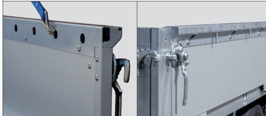
Die zum Gebrauchsmuster angemeldeten Zurrschienen bieten zum einen die Möglichkeit Kleingeräte oder Material daran zu verzurren, zum anderen sind sie ein massiver Rammschutz und schützen so die Bordwände. Die an der Außenkante eingeschweißten Zapfen sind perfekt für die schnelle Sicherung von losem Ladegut mit Hilfe eines Netzes. Die Zurrschienen haben vorne und hinten an den Stirnflächen eine Reinigungsöffnung, falls sich doch mal Schmutz ansammelt. → siehe Seite 4
