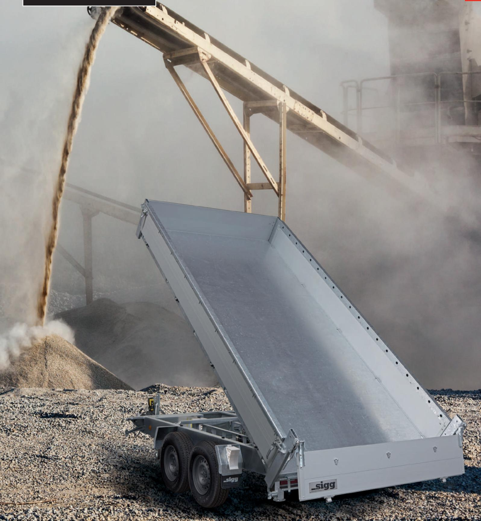
Befahren mit schwerem Gerät, Transport von Schüttgut jeder Art, bequemes Abkippen in drei Richtungen – für die Kipp-Anhänger der Serie KP-S das kleine Einmaleins! Ausgestattet mit einer massiven Rahmenkonstruktion, sind diese Anhänger für den harten Arbeitsalltag konzipiert. Der großdimensionierte Kippzylinder in Kombination mit der optionalen Elektropumpe kippt das Ladegut bequem in die gewünschte Richtung ab. So macht Arbeit Spaß!
