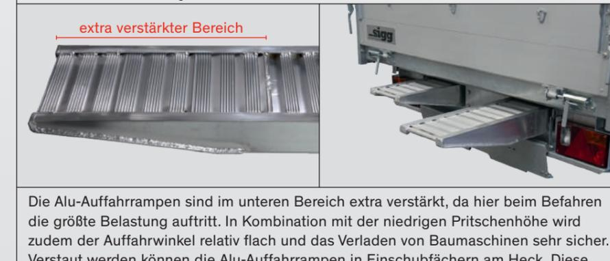
Die Alu-Auffahrampen sind im unteren Bereich extra verstärkt, da hier beim Befahren die größte Belastung auftritt. In Kombination mit der niedrigen Pritschenhöhe wird zudem der Auffahrwinkel relativ flach und das Verladen von Baumaschinen sehr sicher. Verstaut werden können die Alu-Auffahrampen in Einschubfächern am Heck. Diese lassen sich außerdem mit einem Schloss gegen Diebstahl sichern.
