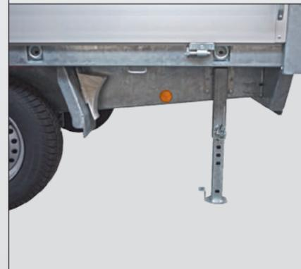
Die stabilen Abstellstützen am Heck sind einfach zu bedienen und bieten zusätzliche Sicherheit während des Verladens von schwerem Gerät.
