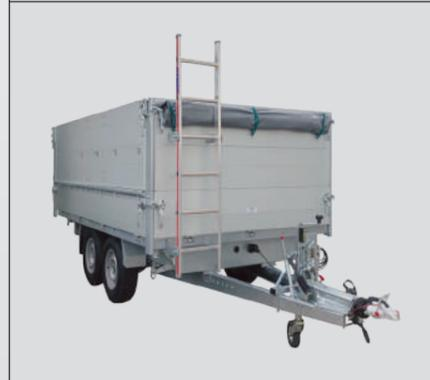
Mit Hilfe der an der Stirnwand rechtsseitig montierten Alu-Leiter können Sie bequem in den Anhänger steigen. Die Leiter ist fest mit den Bordwänden verschraubt, kann jedoch bei Bedarf mit wenigen Handgriffen abmontiert werden.
