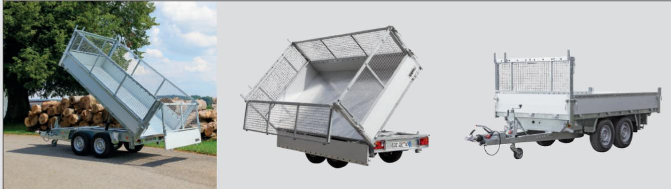
Der 700 mm hohe Stahlgitteraufsatz ist ein unverzichtbarer Helfer, wenn es um den Transport von grobteiligem Schüttgut geht. Rundum feuerverzinkt ist er robust und von langer Lebensdauer. Der Stahlgitteraufsatz ist an den Seitenwänden und am Heck mit Pendelverschlüssen ausgestattet und pendelt somit
