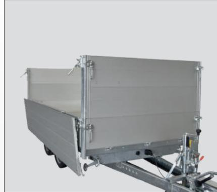
Leichtes Beladen von der Seite, auch mit Aufsatz: Mit dieser Option können Sie die rechte, linke oder beide Seiten des Aufsatzes abklappen und den Anhänger leicht von der Seite aus beladen. Plus: Auch die untere Bordwand kann geöffnet werden.
