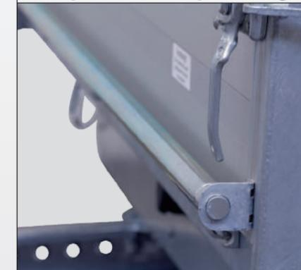
In der Parkposition kann die Sperrstange bei Nicht-Gebrauch sicher verstaut werden und bleibt doch jederzeit einsatzbereit. Die Parkposition kann entweder am Rahmen oder an einem Stirnwandgestell montiert werden.
