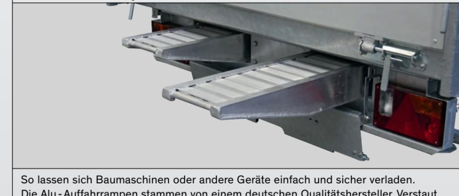
So lassen sich Baumaschinen oder andere Geräte einfach und sicher verladen. Die Alu - Auffahrampen stammen von einem deutschen Qualitätshersteller. Verstaute werden können die Alu-Auffahrampen in Einschubfächern am Heck. Diese lassen sich außerdem mit einem Schloss gegen Diebstahl sichern.
