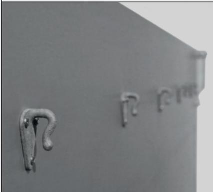
Die Verwendung eines Netzes zur Ladungssicherung wird mit diesen massiven Metallhaken einfacher denn je. Montiert sind die Haken außen an den Bordwänden oder außen am Aufsatz und stehen so jederzeit zur Verfügung.
