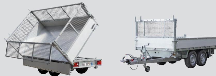
Der 700 mm hohe Stahlgitteraufsatz ist ein unverzichtbarer Helfer, wenn es um den Transport von grobteiligem Schüttgut geht. Rundum feuerverzinkt ist er robust und von langer Lebensdauer. Der Stahlgitteraufsatz ist am Heck und bei einem 3-Seiten-Kipper auch an den Seitenwänden mit Pendelverschlüssen ausgestattet.
