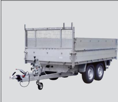
Stirnwandgestell und Alu-Aufsatz in einem heißt: Geringerer Luftwiderstand, Verzurrmöglichkeiten an der Stirnwand, Ladevolumenverdopplung und hervorragende Abkippeigenschaften. Das 700 mm hohe Stirnwandgestell kann separat genutzt werden.
