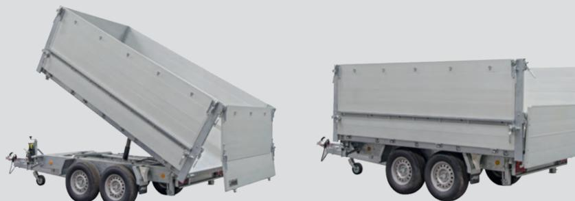
Die 700 mm hohe Variante des Alu-Aufsatzes sprengt alle Dimensionen: Gefertigt aus durchgehend doppelwandigen Alu-Profilen und auf Wunsch aus Mammut-Profilen, hält er extremen Belastungen stand und fasst das dreifache des ursprünglichen Ladevolumens. Auch bei diesem Aufsatz pendelt die hintere Bordwand
