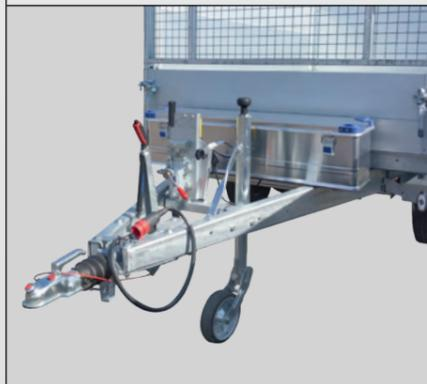
Mit der praktischen Staubox sind die wichtigsten Gegenstände (Netz, Spanngurte etc.) immer an Bord. Auf der Deichsel\* oder am Stirnwandgestell montiert.
