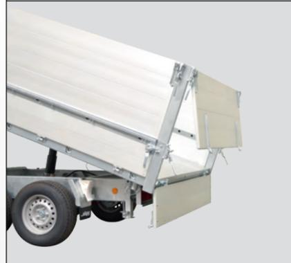
Komfortabler Zugang: Die hintere Aufsatzwand ist hier abklappbar. So kann der Anhänger auch bei aufgesetztem Aufsatz leicht be- und entladen werden.
