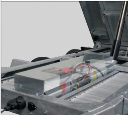
Abkippen per Knopfdruck: Die Elektropumpe erleichtert Ihnen die Arbeit ganz erheblich. Sie wird von einer eigenen leistungsstarken Marken-Batterie (88 Ah) betrieben und ist gemeinsam mit dieser unter einer Abdeckung geschützt eingebaut.
