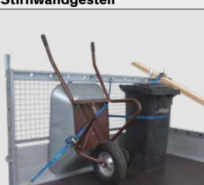
Am feuerverzinkten Stirnwandgestell, 700 mm hoch, lässt sich Handwerkszeug, Kleingeräte oder Langmaterial einfach befestigen und sicher transportieren. Abnehmbar.
