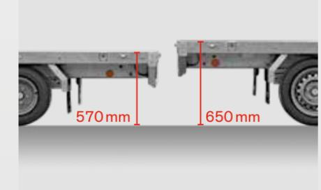
Individuell wählbar: Bei den gebremsten Anhängern mit 1300 kg und 1500 kg kann zwischen zwei Bereifungsvarianten gewählt werden: 10"-Räder (ergibt eine Pritschenhöhe von ca. 570 mm) und 13"-Räder (ergibt eine Pritschenhöhe von ca. 650 mm). Bei den gebremsten Anhängern mit 1600 kg ist nur die 13"-Bereifung möglich.
