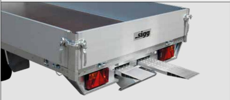
Mit den Alu - Auffahrampen verladen Sie Kleinmaschinen wie Rasenmäher einfach und sicher. Die Alu - Auffahrampen stammen von einem deutschen Qualitätshersteller. Verstaut werden können sie in abschließbaren Einschubfächern am Heck.
