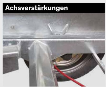
Zusätzlich eingeschweißte Verstärkungen im Achsbereich leiten die auftretenden Kräfte optimal in den Rahmen ein.
