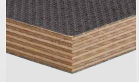
Extrem robuster Boden aus wasserfest verleimter Sperrholzplatte (finnisches Birken-sperrholz, 13-fach verleimt, 18 mm stark) mit rutschhemmender Siebdruckoberfläche.
