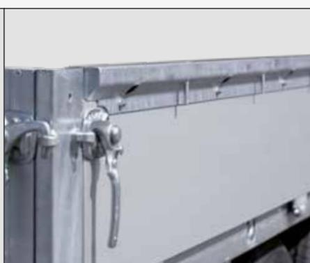
Die zum Gebrauchsmuster angemeldeten Zurrschienen bieten zum einen die Möglichkeit, Kleingeräte oder Material daran zu verzurren, zum anderen sind sie ein massiver Rammschutz und schützen so die Bordwände.
