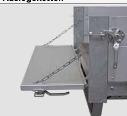
Für Langmaterial: Optional können Sie die vordere und hintere Bordwand mit Auslegeketten ausrüsten. So lassen sich die Bordwände waagrecht hängen und überlanges Ladegut sicher transportieren.
