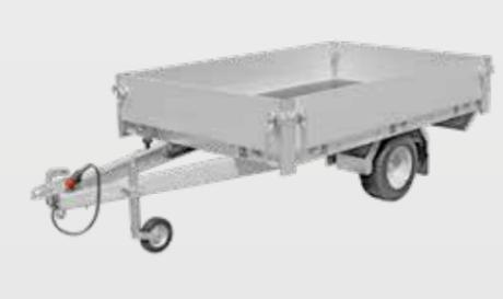
Kompromisslos im Hinblick auf Stabilität, Sicherheit und Fahrkomfort: Auch die Anhänger ohne Bremse sind bei SIGG serienmäßig mit einem Top-Fahrwerk ausgerüstet, nämlich mit dem Längsträgerfahrwerk mit integrierter V-Deichsel. Zudem ist eine starke 10"-Bereifung serienmäßig!
