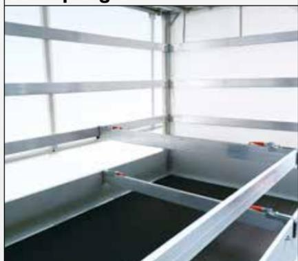
Optional können Alu-Spiegel für das Verdeckgestell gewählt werden. Für den Einsatz von Spannlaten bei der Ladungssicherung sind Spiegel in Alu-Ausführung Voraussetzung (anstelle von Holz-Spiegeln).
