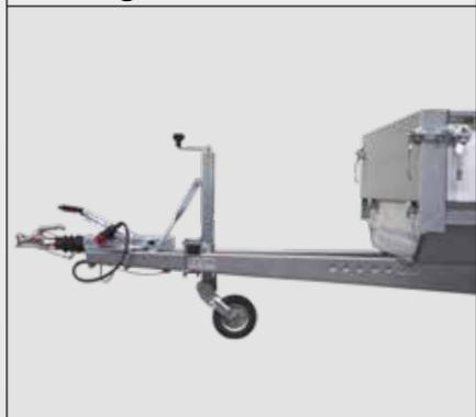
Die verlängerte V-Deichsel ist ideal für alle, die oft lange Sachen wie z.B. Bretter, Balken, Rohre etc. transportieren und dazu die Bordwände abklappen müssen.
