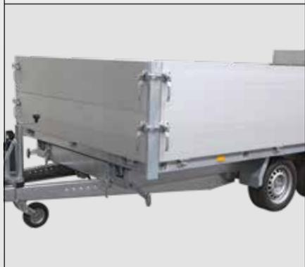
Mit wenigen Handgriffen kann ein 350 mm hoher Aufsatz montiert und so das Ladevolumen verdoppelt werden. Der Aufsatz ist aus durchgehend doppelwandigen, eloxierten Alu-Profilen gefertigt – auf Wunsch auch aus Mammut-Profilen.
