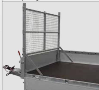
Am massiven Transportgestell, 1500 mm hoch, können Sie z.B. Gerüstteile senkrecht transportieren. Es ist selbstverständlich auch im Tauchbad feuerverzinkt.
