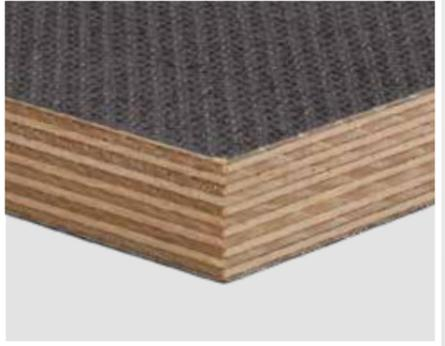
Extrem robuster Boden aus wasserfest verleimter Sperrholzplatte (finnisches Birken-sperrholz, 13-fach verleimt, 18 mm stark) mit rutschhemmender Siebdruckoberfläche.
