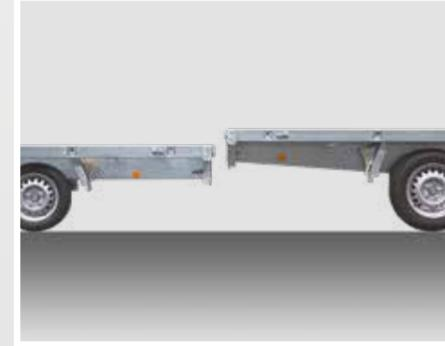
Für jeden Einsatzzweck die richtige Höhe: Sie können zwischen zwei Pritschenhöhen wählen. Eine niedrige Spezialbereifung sorgt für die geringe Pritschenhöhe.
