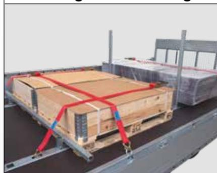
Sicherungsrungen und -traversen, die zusätzlich in das FloorFixSystem eingesteckt werden können, sichern das Ladegut vor dem Verrutschen und ermöglichen eine formschlüssige Ladungssicherung.
