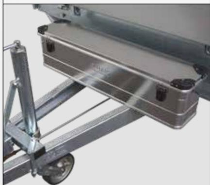
Bei normaler Pritschenhöhe kann auf der Deichsel eine Staubox aus Aluminium montiert werden. Bei Wahl eines Stirnwandgestells kann sie alternativ an selbigem befestigt werden. Größe außen: 1100 x 250 x 277 mm
