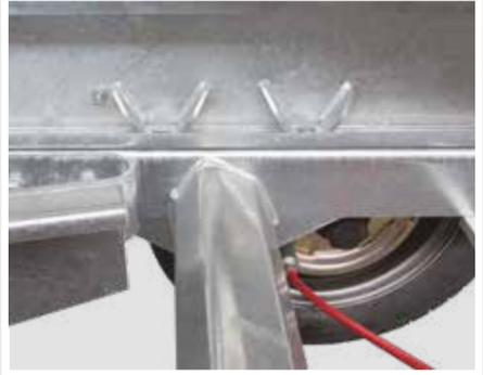
Zusätzlich eingeschweißte Verstärkungen im Achsbereich leiten die auftretenden Kräfte optimal in den Rahmen ein.
