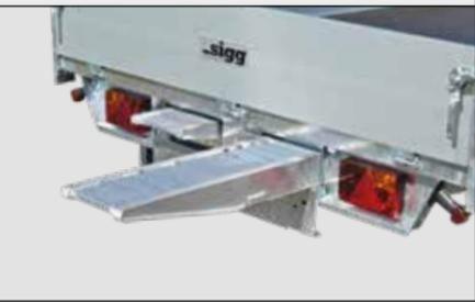
Als Option können Sie Alu-Verladeschienen erhalten, die am Heck in Einschubfächern unterhalb der Pritsche verstaut werden können. In Verbindung mit der niedrigen Bereifung wird der Auffahrwinkel flach und das Befahren mit Baumaschinen somit sehr sicher. Die Schienen sind im unteren Bereich mit speziellen Profilen extra verstärkt, da beim Auffahren hier die größte Belastung auftritt. Zudem haben die Schienen in der Mitte über die gesamte Länge einen zusätzlichen Unterzug eingeschweißt.
