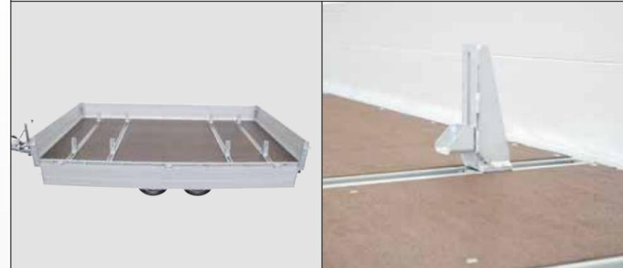
Mit den feuerverzinkten Spannpratzen können Sie in Verbindung mit dem C-Profil eine Transportbox, z.B. zum Transport von Glas, auf der Pritsche befestigen. Das C-Profil dient zur Befestigung der optional erhältlichen Spannpratzen. Innenmaße ca. 77 x 34 mm. Öffnungsweite ca. 41 mm.
