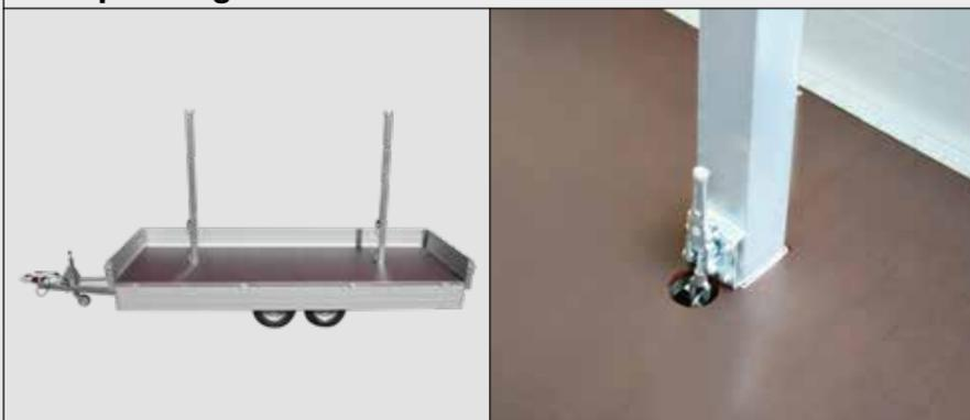
Die Transportrungen sind im Bereich der Ladungssicherung unabdingbar: Mittels der optional erhältlichen Einsteckhülsen können Sie mit den 2500 mm hohen Transportrungen z.B. Wandscheiben aufrecht für den Transport fixieren. Die Einsteckhülse wird fest mit dem Rahmen verschweißt und dient zur Befestigung der optional erhältlichen Transportrungen.
