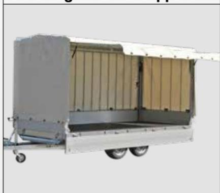
Eine Ausführungsvariante beim Verdeckgestell: Eine oder mehrere Seiten können mit Gasfederunterstützung aufgeklappt werden. Damit haben Sie zugleich auch einen einfachen Witterungsschutz für Arbeiten im Anhänger.
