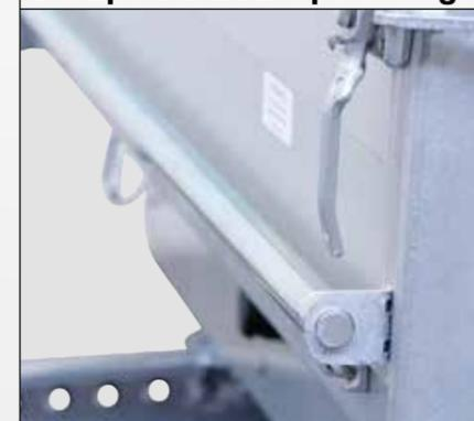
In der Parkposition kann die Sperrstange bei Nicht-Gebrauch sicher verstaut werden und bleibt doch jederzeit einsatzbereit. Die Parkposition kann entweder an der vorderen Bordwand oder an einem Stirnwandgestell montiert werden.
