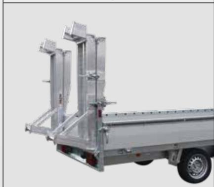
Wer oft mit Maschinen auf den Anhänger fährt, der braucht eine schnelle Lösung. Dazu bieten wir die fest am Heck adaptiert und abklappbaren Alu-Verladeschienen an. Auf Wunsch sind die Verladeschienen in der Mitte geteilt.
