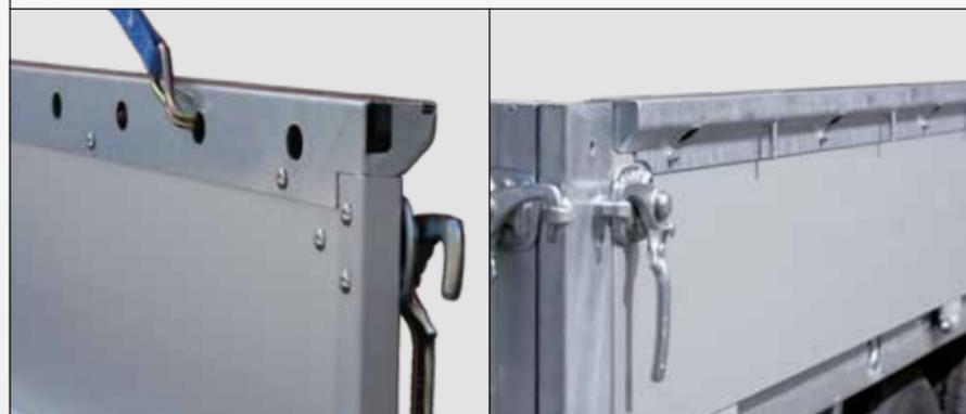
Die zum Gebrauchsmuster angemeldeten Zurrschienen bieten zum einen die Möglichkeit, Kleingeräte oder Material daran zu verzurren, zum anderen sind sie ein massiver Rammschutz und schützen so die Bordwände. Sie lassen sich links und rechts, vorne und hinten oder gekoppelt einsetzen.
