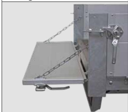
Optional können Sie die vordere und hintere Bordwand mit Auslegeketten ausrüsten. So lassen sich die Bordwände waagrecht hängen.
