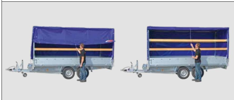
Um das Öffnen und Schließen der Plane bei langen Anhängern und hohen Verdeckaufbauten zu erleichtern, rüsten wir Ihren Anhänger optional mit einem Feder-Rollo aus. Damit lässt sich die Plane elegant öffnen und bleibt auch bei widrigen Wetterbedingungen oben.
