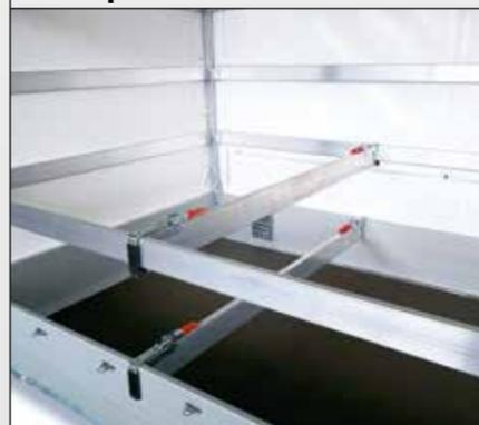
Zur formschlüssigen Ladungssicherung hoher Ladegüter: Die Alu-Spannlatten können flexibel und stufenlos an den Bordwänden und Alu-Spiegeln positioniert werden.
