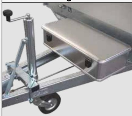
Bei niedriger Pritschenhöhe kann auf der Deichsel eine Staubox aus Aluminium montiert werden. Diese bietet Stauraum für Kleinteile wie Spanngurte, Netz ect. Größe außen: 782 x 385 x 190 mm
