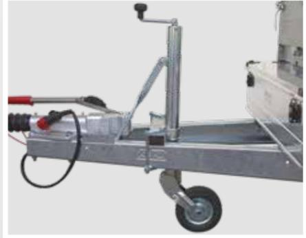
Serienmäßig verstärktes Stützrad. Zwischen der V-Deichsel auf einer Traverse montiert. Es hat eine Abstützung auf die Deichsel (bei 3500 kg zul. Ges.Gew. zwei Abstützungen.)
