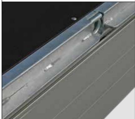
Der massive Rammschutz außen am Rahmen schützt beim Be- oder Entladen die Bordwände gegen das Anfahren mit dem Stapler.
