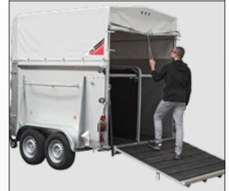
Komfortabel: Mit dem integrierten Federrollo öffnen und schließen Sie die Heckplane einfacher und schneller denn je.
