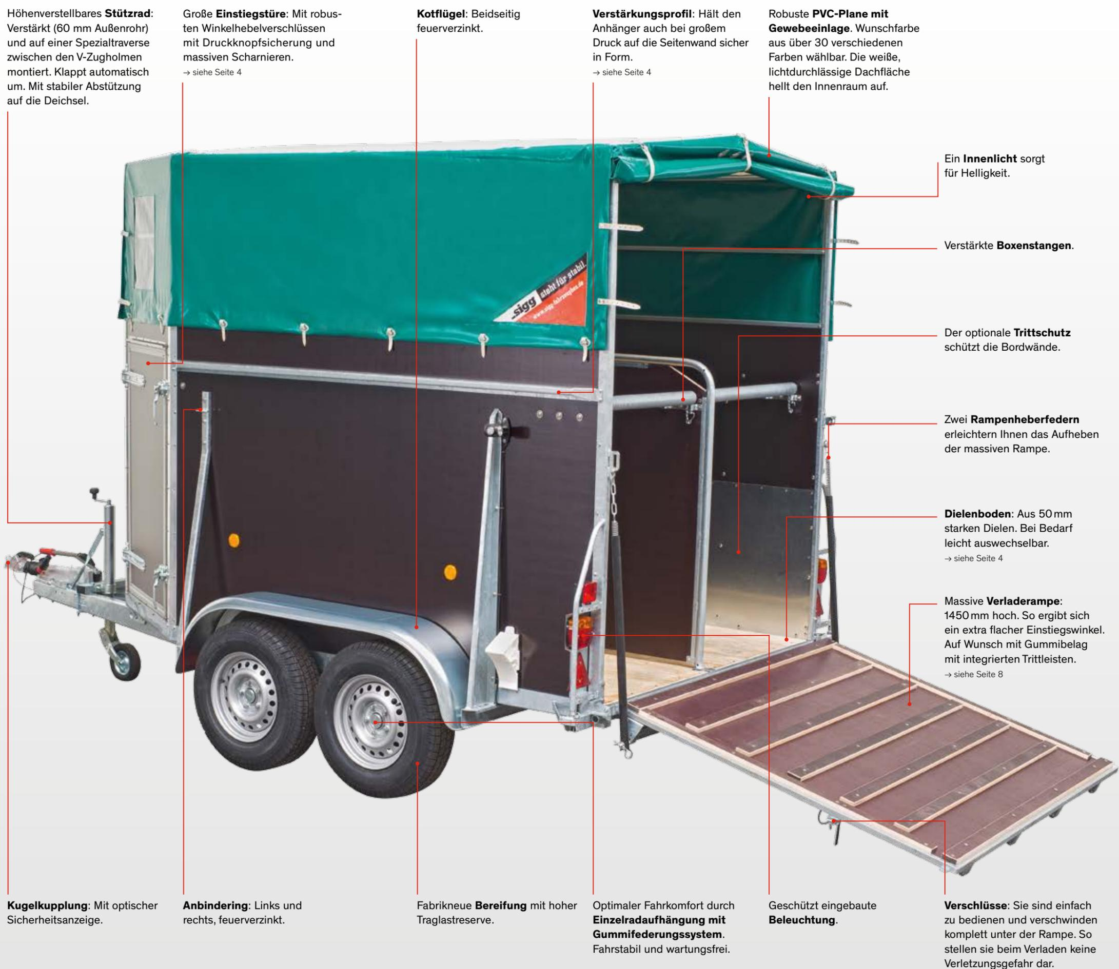
**Höhenverstellbares Stützrad:** Verstärkt (60 mm Außenrohr) und auf einer Spezialtraverse zwischen den V-Zugholmen montiert. Klappt automatisch um. Mit stabiler Abstützung auf die Deichsel.
