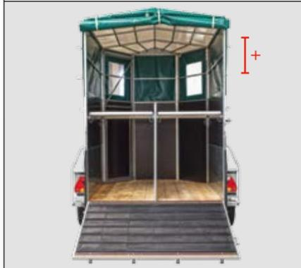
Für mehr Kopf-Freiheit: Der Innenraum kann wahlweise um 100 mm oder 200 mm erhöht werden.
