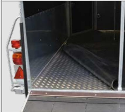
Diese Gummimatte dämpft die Tritte und sorgt für einen sicheren Stand. Ausgelegt ist sie für ein Pferdengewicht bis 600 kg. Zur Reinigung kann sie am Stück herausgenommen werden.
