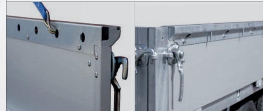
Die zum Gebrauchsmuster angemeldeten Zurrschienen bieten zum einen die Möglichkeit, Kleingeräte oder Material daran zu verzurren, zum anderen sind sie ein massiver Ramschutz und schützen so die Bordwände.
