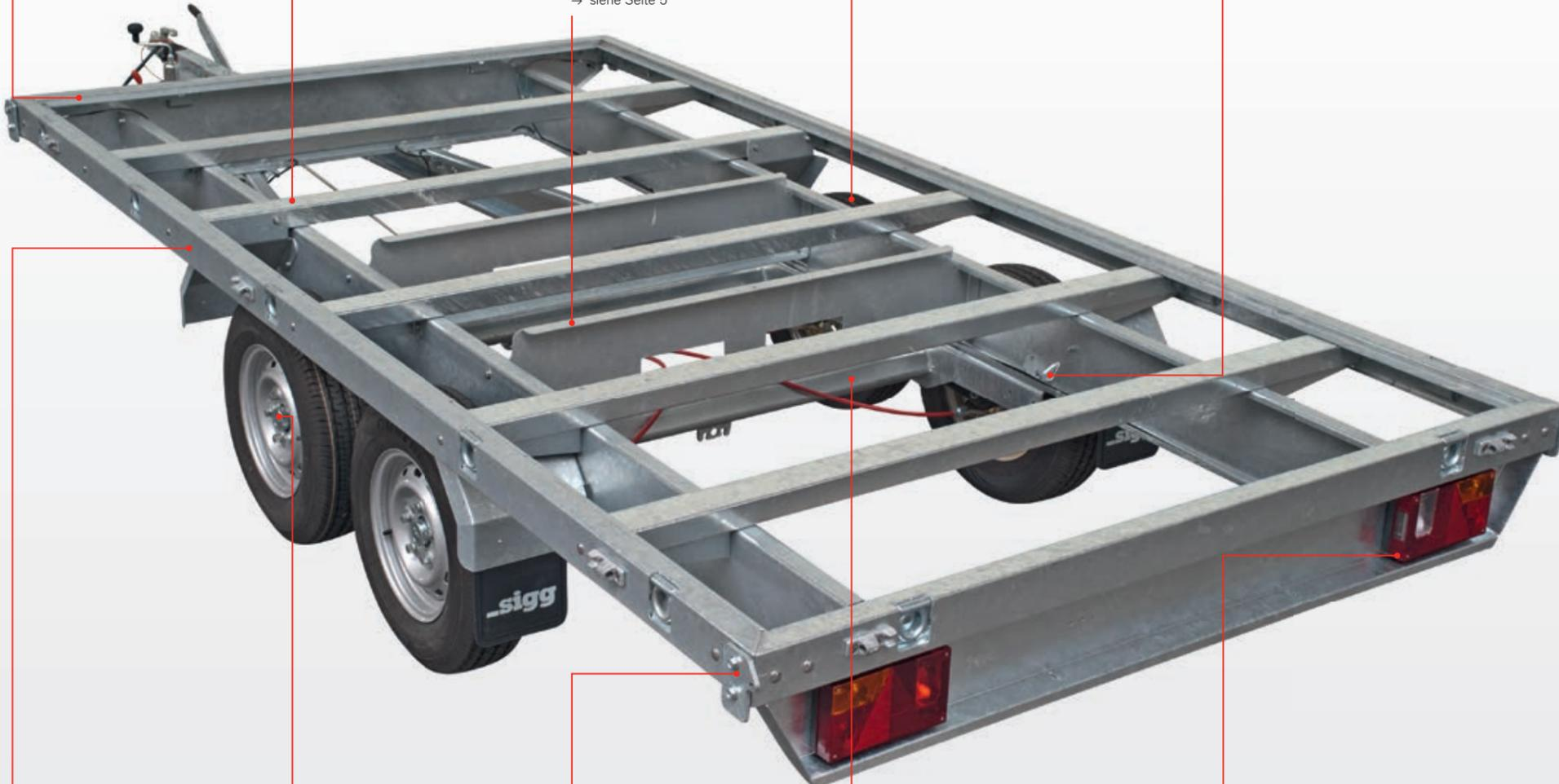
Stabile, **verwindungssteife Rahmenkonstruktion** mit einem 90 mm (!) hohen Bodenauflagerahmen mit extra hoher Sicherheitsreserve.
