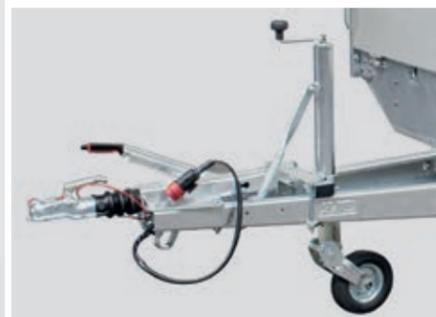
Serienmäßig verstärktes Stützrad. Zwischen der V-Deichsel auf einer Traverse montiert. Es hat eine Abstützung auf die Deichsel. Es klappt zudem automatisch um.
