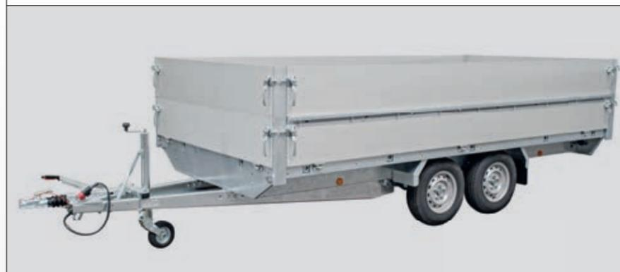
Mit wenigen Handgriffen kann ein 350 mm hoher Aufsatz montiert und so das Ladevolumen verdoppelt werden. Der Aufsatz ist ebenfalls aus durchgehend doppelwandigen, eloxierten Alu-Profilen gefertigt – auf Wunsch auch aus Mammut-Profilen.
