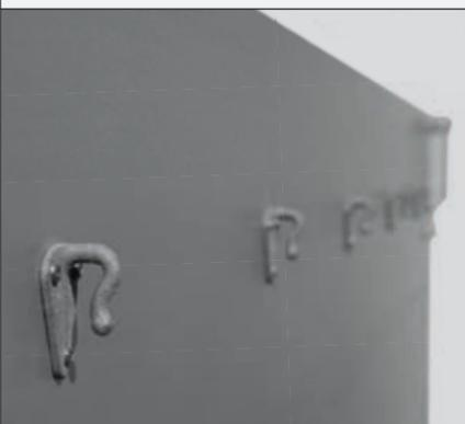
Die Verwendung eines Netzes zur Ladungssicherung wird mit den massiven Metallhaken, die außen an den Bordwänden oder außen am Aufsatz montiert werden, zum Kinderspiel.
