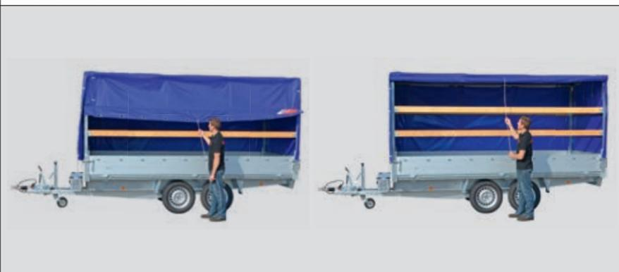
Um das Öffnen und Schließen der Plane bei langen Anhängern und hohen Verdeckaufbauten zu erleichtern, rüsten wir Ihren Anhänger optional mit einem Feder-Rollo aus. Damit lässt sich die Plane elegant öffnen und bleibt auch bei widrigen Wetterbedingungen oben.
