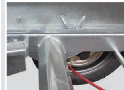
Zusätzlich eingeschweißte Verstärkungen im Achsbereich leiten die auftretenden Kräfte optimal in den Rahmen ein.
