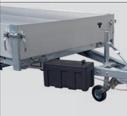
In dieser Staubox bringen Sie ein Netz und Zurrgurte bequem unter. Die Staubox ist abschließbar. Größe außen: 515 x 220 x 277 mm
