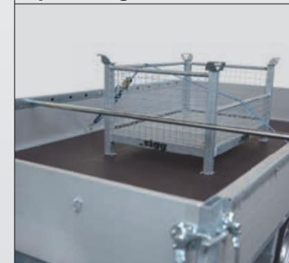
Flexibel an den innenliegenden Öffnungspunkten der Zurrschienen einsetzbar, dient die Sperrstange zur formschlüssigen Ladungssicherung. Ausgelegt ist die Sperrstange für eine gleichmäßig verteilte Haltekraft von 400 daN (400 kg).
