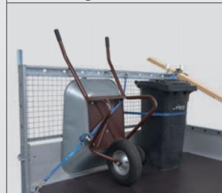
Am feuerverzinkten Stirnwandgestell, 650 mm hoch, lässt sich Handwerkszeug, Kleingeräte oder Langmaterial einfach befestigen und sicher transportieren. Abnehmbar.
