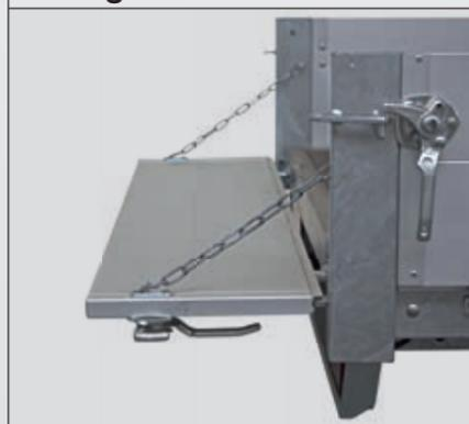
Optional können Sie die vordere und hintere Bordwand mit Auslegeketten ausrüsten. So lassen sich die Bordwände waagrecht hängen.
