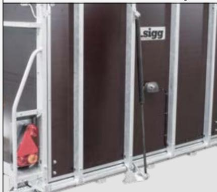
Bis zu zwei Gasfedern unterstützen das Aufheben der stabilen Rampe. In Kombination mit der dreh- und klappbaren Laderampe lässt diese sich um ca. 180° zur Seite schwenken.
