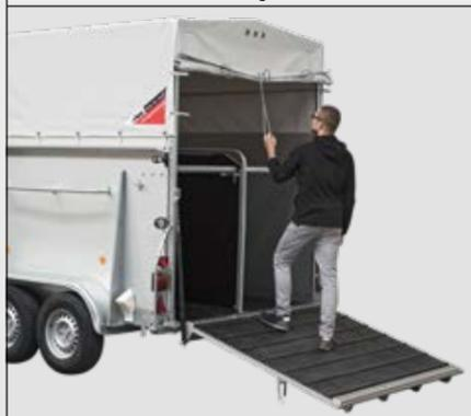
Komfortabel: Mit dem integrierten Federrollo öffnen und schließen Sie die Heckplane einfacher und schneller denn je.
