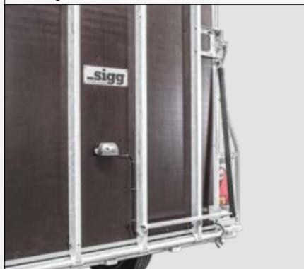
Die Laderampe kann mit bis zu zwei Rampenheberfedern ausgestattet werden. Diese erleichtern Ihnen das Öffnen und Schließen der stabilen Rampe.
