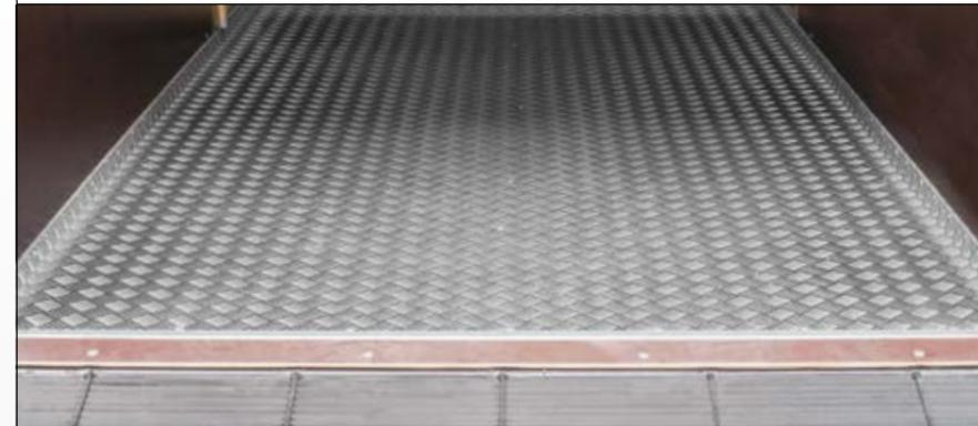
Unverrottbar: Ausgestattet mit einer Bodenwanne aus Alu-Riffelblech, die auf einer GFK-Wabenplatte aufliegt, ist diese Bodenvariante äußerst langlebig. Die Bodenwanne ist vorne und seitlich aufgekantet und an den Ecken verschweißt. Das robuste Alu-Riffelblech ist zudem leicht zu reinigen und steckt die Strapazen des täglichen Gebrauchs locker weg.
