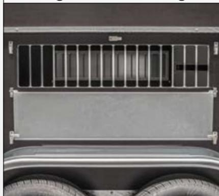
Lüftungen an den Seiten (950 x 210 mm oder 450 x 210 mm) sorgen für ein gutes Klima während des Transports. Bei Nicht-Gebrauch kann die Öffnung von außen durch eine Klappe verschlossen werden.
