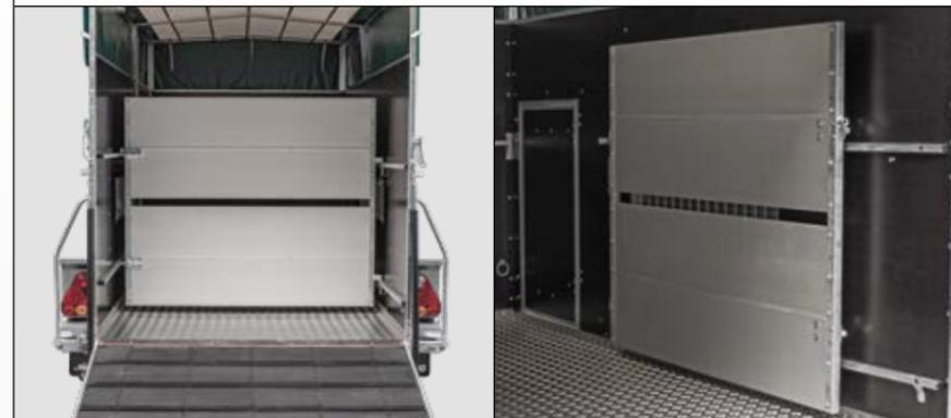
Die robuste Trennwand aus eloxierten Aluminium-Profilen teilt den Innenraum des Anhängers in verschiedene Abteile auf. Sie ist in den Höhen 1250 mm und 1450 mm erhältlich. Eingesetzt wird die Trennwand an vier Ösen an der Bordwand. Von dort aus kann sie leicht zur Seite geschwenkt oder mit wenigen Handgriffen komplett entfernt werden. Das Bild zeigt die Trennwand in Kombination mit Lochleisten (siehe rechts).
