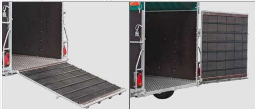
Vielseitig: Die Rampe lässt sich durch diese Sonderausstattung sowohl nach unten klappen als auch zur Seite schwenken. Wenige Handgriffe ermöglichen so eine flexible Nutzung des Anhängers weit über den reinen Viehtransport hinaus. Mit zur Seite geschwenkter Rampe lässt sich der Anhänger beispielsweise leicht mit einem Frontlader oder Stapler beladen. In Kombination mit einer Gasfeder an der Laderampe lässt sich diese sogar um nahezu 180° aufschwenken.
