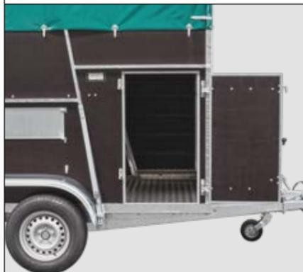
Die Drehtüre (1000 x 550 mm) erleichtert Ihnen den Zugang in den Innenraum des Anhängers. Zwei massive Winkelhebelverschlüsse mit Druckknopfsicherung sichern sie. Sie ist rechts, links oder auch beidseitig erhältlich.
