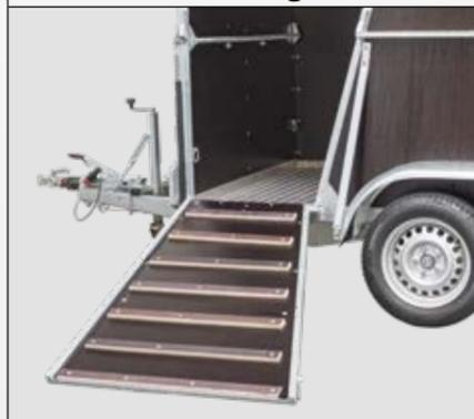
Über den Seitenausladesteg können die Tiere auch bequem und stressfrei nach vorne ausgeladen werden. Das Öffnen und Schließen wird durch zwei großdimensionierte Rungenverschlüsse mit extra langen Hebeln erleichtert.
