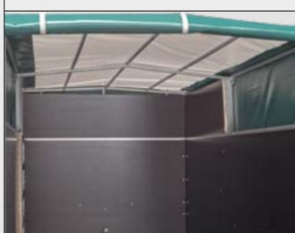
Bei diesem Planenschutz ist an der Stirnseite und seitlich rechts im vorderen Drittel des Verdeckgestells eine Platte aus wasserfest verleimtem Birkenperrholz verbaut.
