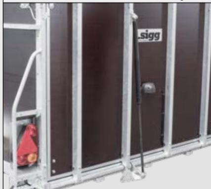
Bis zu zwei Gasfedern unterstützen das Aufheben der stabilen Rampe. In Kombination mit der dreh- und klappbaren Laderampe lässt sich diese sich um ca. 180° zur Seite schwenken.
