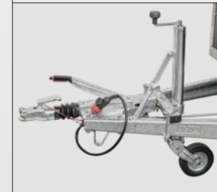
Das verstärkte Stützrad (60 mm Außenrohr) ist höhenverstellbar und auf einer Spezialtraverse montiert. Mit stabiler Abstützung auf die Deichsel. Es klappt zudem automatisch um.
