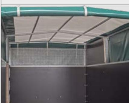
Der Planenschutz aus verzinktem Lochblech vorne und einer Platte aus wasserfest verleimtem Birkenperrholz rechts im vorderen Drittel erhöht die Lebensdauer der Plane und ermöglicht eine gute Belüftung des Anhängers.
