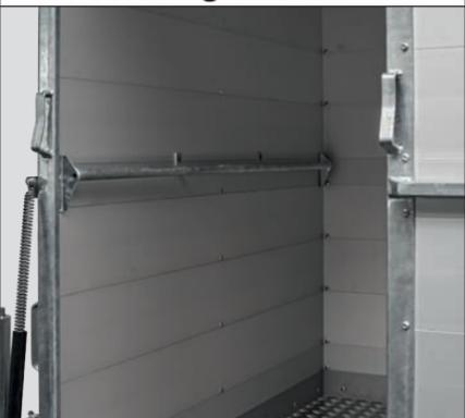
Die Anbindestange ermöglicht ein flexibles Anbinden und ersetzt den oberen Anbindering. Selbstverständlich ist sie feuerverzinkt und so bestens gegen Korrosion geschützt.
