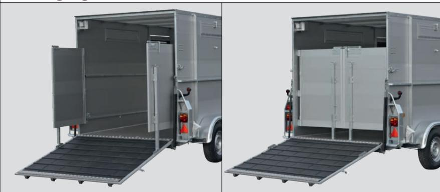
Entspannt: Die sogenannte Ranger-Türe ermöglicht ein Öffnen der Heckklappe ohne ein vorschnelles Herauspringen der Tiere. Nach dem Öffnen lassen sich die Flügel an Haltepunkten auf der Heckklappe fixieren. Auch beim Verladen leistet die zweiflügelige Hecktüre als seitliche Begrenzung gute Dienste.
