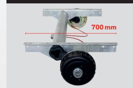
Achsen für höchste Ansprüche: Die speziell für die SIGG-Anhänger gefertigten Achsen haben einen 700 mm langen, feuerverzinkten Achsbock und sind pro Achse achtfach mit den Längsträgern des Anhängerchassis verschraubt. Dies gewährleistet eine besonders gute Fahrstabilität. Zudem ist der Achskörper im Tauchbad feuerverzinkt und damit bestens gegen Korrosion geschützt.
