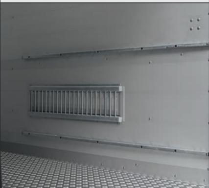
Bleiben Sie flexibel: Die Lochleisten ermöglichen Ihnen je nach Einsatzzweck eine nahezu stufenlose Anpassung der Trennwand. Auch der Einsatz mehrerer Trennwände ist problemlos möglich.
