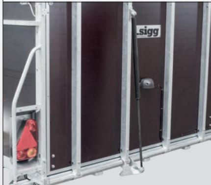
Bis zu zwei Gasfedern unterstützen das Aufheben der stabilen Rampe. In Kombination mit der dreh- und klappbaren Laderampe lässt sich diese um ca. 180° zur Seite schwenken.
