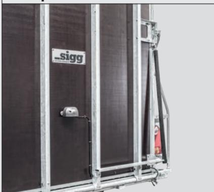
Die Laderampe kann mit bis zu zwei Rampenhebefedern ausgestattet werden. Diese erleichtern Ihnen das Öffnen und Schließen der stabilen Rampe.
