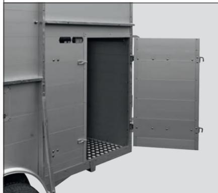
Die Drehtüre erleichtert Ihnen den Zugang in den Innenraum des Anhängers. Zwei massive Winkelhebelschlüsse mit Druckknopfsicherung sichern sie. Sie ist rechts, links oder auch beidseitig erhältlich.
