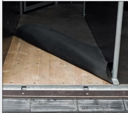
Die Gummimatte dämpft die Tritte und sorgt für einen sicheren Stand. Ausgelegt ist sie für ein Gewicht pro Tier von 600 kg. Zur Reinigung kann sie am Stück herausgenommen werden. Alternativ ist sie auch fest verklebt erhältlich.
