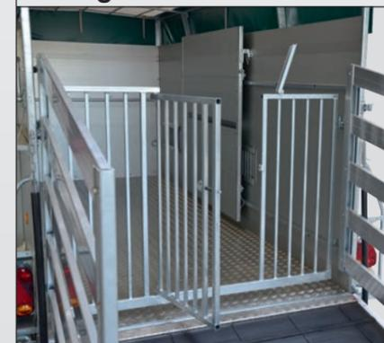
Das Trenngitter mit Türe ist feuerverzinkt. Bei geöffneter Türe ist der Durchgang oben frei, sodass man bequem durchlaufen kann.
