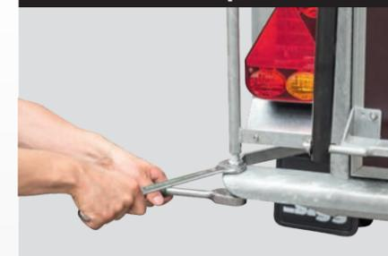
Die Eckpfosten lassen sich durch ein spezielles Gewinde nachjustieren. So kann das Spaltmaß zwischen den seitlichen Bordwänden und der Heckklappe reguliert werden. Die Verschlüsse bleiben damit leichtgängig, auch wenn die seitlichen Bordwände während des Einsatzes den einen oder anderen Schlag abbekommen haben sollten.
