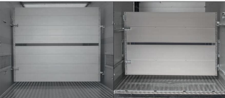
Die robuste Trennwand aus eloxierten Aluminium-Profilen teilt den Innenraum des Anhängers in verschiedene Abteile auf. Sie ist in den Höhen 1250 mm und 1450 mm erhältlich und durch Einhängeösen an den Seiten des Anhängers arretiert. Sie kann zum Heck des Anhängers aufgeschwenkt oder mit wenigen Handgriffen komplett entfernt werden.
