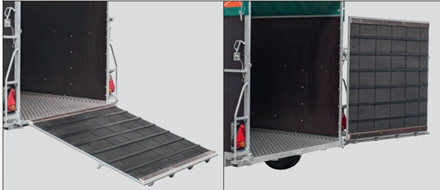
Vielseitig: Die Rampe lässt sich durch diese Sonderausstattung sowohl nach unten klappen als auch zur Seite schwenken. Wenige Handgriffe ermöglichen so eine flexible Nutzung des Anhängers weit über den reinen Viehtransport hinaus. Mit zur Seite geschwenkter Rampe lässt sich der Anhänger beispielsweise leicht mit einem Frontlader beladen. In Kombination mit einer Gasfeder an der Laderampe, lässt sich diese sogar um nahezu 180° aufschwenken.
