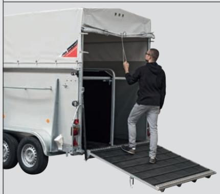
Komfortabel: Mit dem integrierten Federrollo öffnen und schließen Sie die Heckplane einfacher und schneller denn je.
