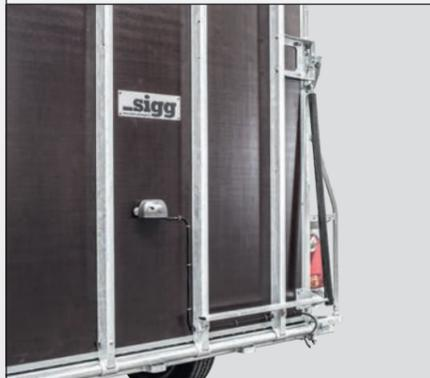
Die Laderampe kann mit bis zu zwei Rampenhebefedern ausgestattet werden. Diese erleichtern Ihnen das Öffnen und Schließen der stabilen Rampe.
