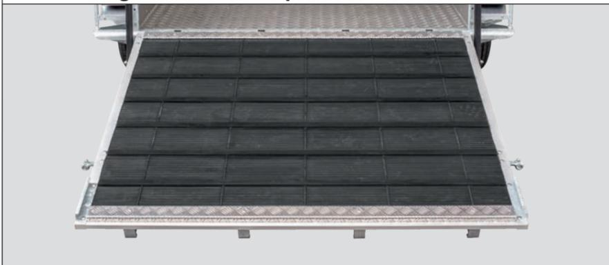
Der Gummibelag mit den integrierten Trittleisten erleichtert dem Vieh das Ein- und Aussteigen, da dieser Belag für einen leisen und weichen Auftritt sorgt und trotzdem extrem griffig ist. Der Gummibelag wird ganzflächig mit einem speziellen Konstruktionskleber verklebt und ist leicht zu reinigen.
