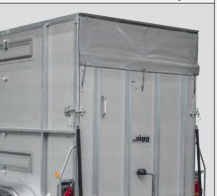
Witterungsschutz: Der Planenlatz schließt die Lücke zwischen der Oberkante der Laderampe und dem Dach. So verhindert er ein Eindringen von Niederschlag und einen unangenehmen Durchzug.
