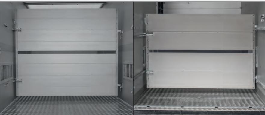
Die robuste Trennwand aus eloxierten Aluminium-Profilen teilt den Innenraum des Anhängers in verschiedene Abteile auf. Sie ist in den Höhen 1250 mm und 1450 mm erhältlich und durch Einhängeösen an den Seiten des Anhängers arretiert. Sie kann zum Heck des Anhängers aufgeschwenkt oder mit wenigen Handgriffen komplett entfernt werden.
