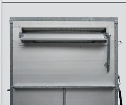
Diese Lüftungsöffnung in der Stirnwand ist durch einen komfortablen Schieber nahezu stufenlos einstellbar. Damit kann sie jederzeit bedarfsgerecht angepasst werden.
