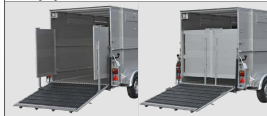
Entspannt: Die sogenannte Ranger-Türe ermöglicht ein Öffnen der Heckklappe ohne ein vorschnelles Herausspringen der Tiere. Nach dem Öffnen lassen sich die Flügel an Haltepunkten auf der Heckklappe fixieren. Auch beim Verladen leistet die zweiflügelige Hecktüre als seitliche Begrenzung gute Dienste.
