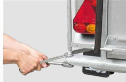
Die Eckpfosten lassen sich durch ein spezielles Gewinde nachjustieren. So kann das Spaltmaß zwischen den seitlichen Bordwänden und der Heckklappe reguliert werden. Die Verschlüsse bleiben damit leichtgängig, auch wenn die seitlichen Bordwände während des Einsatzes den einen oder anderen Schlag abbekommen haben sollten.
