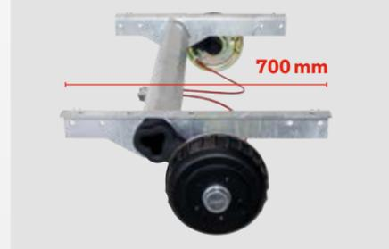
Achsen für höchste Ansprüche: Die speziell für die SIGG-Anhänger gefertigten Achsen haben einen 700 mm langen, feuerverzinkten Achsbock und sind pro Achse achtfach mit den Längsträgern des Anhängerchassis verschraubt! Dies gewährleistet eine besonders gute Fahrstabilität. Zudem ist der Achskörper im Tauchbad feuerverzinkt und damit bestens gegen Korrosion geschützt.
