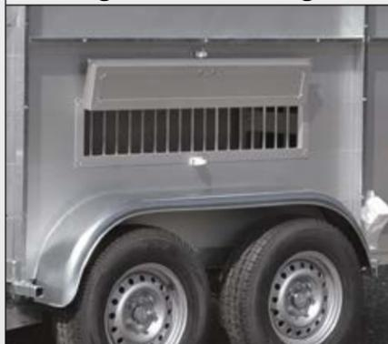
Klimafreundlich: Die 1100 mm oder 600 mm langen Lüftungsöffnungen an den Seiten sorgen für genügend Frischluft. Der komfortable Verschluss ermöglicht ein Öffnen und Schließen mit nur einer Hand.
