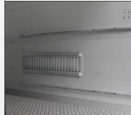
Bleiben Sie flexibel: Die Lochleisten ermöglichen Ihnen je nach Einsatzzweck eine nahezu stufenlose Anpassung der Trennwand. Auch der Einsatz mehrerer Trennwände ist problemlos möglich.
