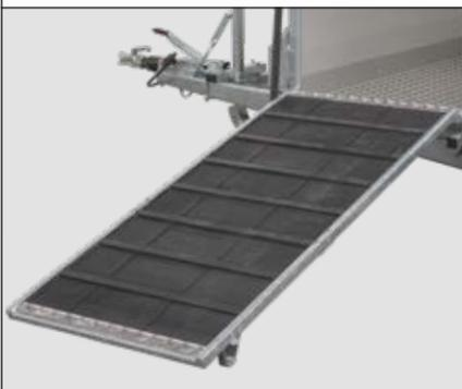
Der Gummibelag mit integrierten Trittleisten auf dem Seitenausladesteg sorgt für Halt und erleichtert den Tieren das Aussteigen. Die ganzflächige Verklebung verhindert eine unangenehme Geruchsbildung.
