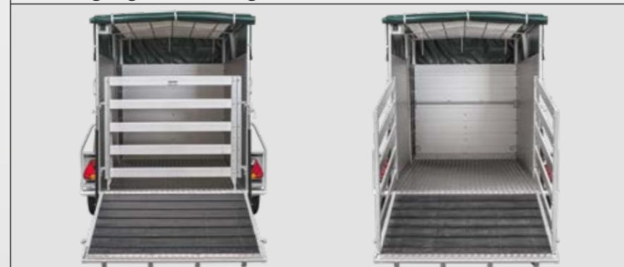
Komfortabel: Das zweiflügelige Scherengitter erleichtert das Verladen der Tiere, da diese nicht zu den Seiten weg können. Während der Fahrt sind die eingeklappten Scherengitter sicher am Heck des Anhängers verstaut. Das Scherengitter ist aus doppelwandigen Alu-Profilen gefertigt.
