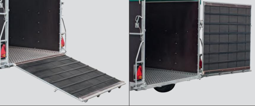
Vielseitig: Die Rampe lässt sich durch diese Sonderausstattung sowohl nach unten klappen als auch zur Seite schwenken. Wenige Handgriffe ermöglichen so eine flexible Nutzung des Anhängers weit über den reinen Viehtransport hinaus. Mit zur Seite geschwenkter Rampe lässt sich der Anhänger beispielsweise leicht mit einem Frontlader beladen. In Kombination mit einer Gasfeder an der Laderampe, lässt sich diese sogar um nahezu 180° aufschwenken.
