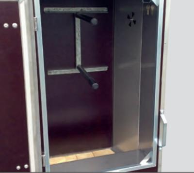
Die in den Anhänger integrierte Sattelkammer aus Edelstahl bietet Platz und Vorrichtungen für zwei Sattel. Sie ragt zur einen Seite in den Innenraum des Anhängers hinein und zur anderen Seite in den Außenraum.
