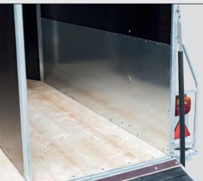
Der Trittschutz aus verzinktem Blech schützt die Bordwände vor dem Verschleiß durch Huftritte. So bleiben die Bordwände intakt. Dies trägt maßgeblich zu deren Langlebigkeit bei.
