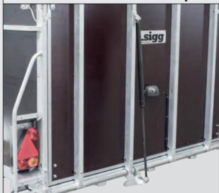
Bis zu zwei Gasfedern unterstützen das Aufheben der stabilen Rampe. In Kombination mit der dreh- und klappbaren Laderampe lässt sich diese sich um ca. 180° zur Seite schwenken.
