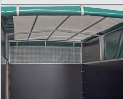
Der Planenschutz aus verzinktem Lochblech vorne und einer Platte aus wasserfest verleimtem Birkenperrholz rechts im vorderen Drittel erhöht die Lebensdauer der Plane und ermöglicht eine gute Belüftung des Anhängers.
