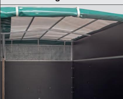
In dieser Variante schützt ein Lochblech vorne und eine Holzplatte an den Seiten die Plane ringsum zuverlässig vor Beschädigungen. Das verzinkte Lochblech ermöglicht bei hochgerollter Plane eine gute Durchlüftung des Anhängers.
