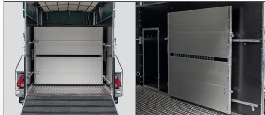
Die robuste Trennwand aus eloxierten Aluminium-Profilen teilt den Innenraum des Anhängers in verschiedene Abteile auf. Sie ist in den Höhen 1250 mm und 1450 mm erhältlich. Eingesetzt wird die Trennwand an vier Ösen an der Bordwand. Von dort aus kann sie leicht zur Seite geschwenkt oder mit wenigen Handgriffen komplett entfernt werden. Das Bild zeigt die Trennwand in Kombination mit Lochleisten (siehe rechts).
