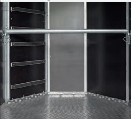
Die starke, feuerverzinkte Bruststange ist für die Tiere eine Begrenzung nach vorn. Bei Bedarf kann sie einfach ausgehängt werden.
