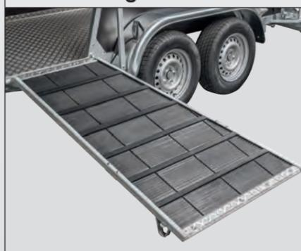
Der Gummibelag mit integrierten Trittleisten auf dem Seitenausladesteg sorgt für Halt und erleichtert den Tieren das Aussteigen. Die ganzflächige Verklebung verhindert eine unangenehme Geruchsbildung.
