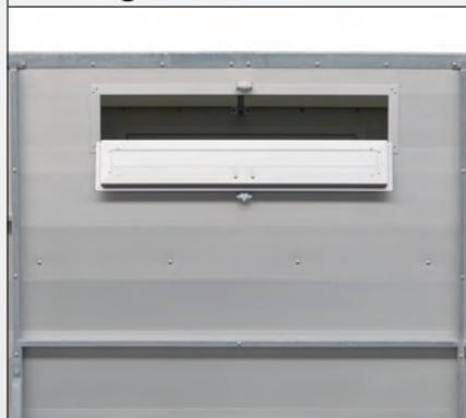
Um das Klima im Anhänger optimal zu regulieren, können zusätzliche Lüftungsöffnungen an der Oberseite eingebaut werden. Abhängig von der Länge des Anhängers, sind zwei, vier oder sechs Lüftungen wählbar. Ausführung in Holz und Alu möglich.
