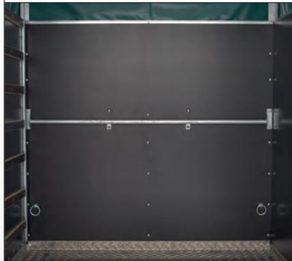
Die Anbindestange ermöglicht ein flexibles Anbinden und ersetzt den oberen Anbinder. Selbstverständlich ist sie feuerverzinkt und so bestens gegen Korrosion geschützt.
