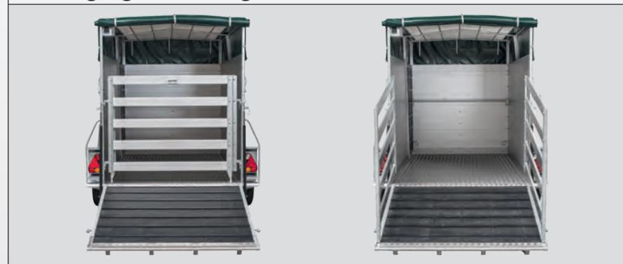
Komfortabel: Das zweiflügelige Scherengitter erleichtert das Verladen der Tiere, da diese nicht zu den Seiten ausweichen können. Während der Fahrt sind die eingeklappten Scherengitter sicher am Heck des Anhängers verstaut. Das Scherengitter ist aus doppelwandigen Alu-Profilen gefertigt.
