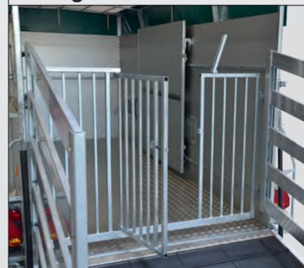
Das Trenngitter mit Türe ist feuerverzinkt. Bei geöffneter Tür ist der Durchgang oben frei, sodass man bequem durchlaufen kann.
